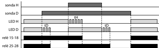
PUMP UP, OFF DELAY (funkce 5)
