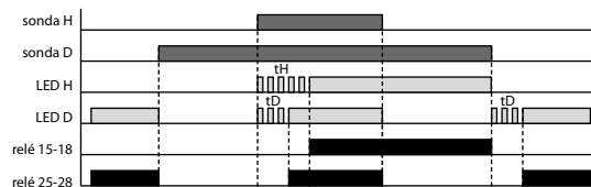
PUMP DOWN, ON DELAY (funkce 6)
