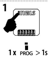
Press of programming button on actuator (e.g. RFSAI-61B-SL) for 1 second will activate actuator into programming mode. LED is flashing in 1s interval. Stiskem programovacího tlačítka na spínací prvku (např. RFSAI-61B-SL) na dobu 1 vteřiny se uvede prvek do programovacího režimu. LED bliká v intervalu 1 vteřiny.
