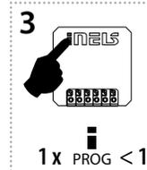
Press of programming button on actuator RFSAI-61B-SL shorter than 1 second will finish programming mode, LED switches off. Stiskem programovacího tlačítka na prvku RFSAI-61B-SL na dobu kratší než 1 vteřina se ukončí programovací režim, LED zhasne.
