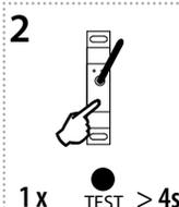
Press and hold the TEST button on RFSG-1M for more than 4s to automatically assign the RFSG-1M transmitter to the actuator. Na RFSG-1M stiskem tlačítka TEST > 4s proběhne automatické přiřazení RF ovladače RFSG-1M ke spínacímu prvku.
